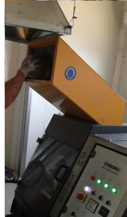
3 Granulatrice Riduzione in granuli e separazione delle componenti
